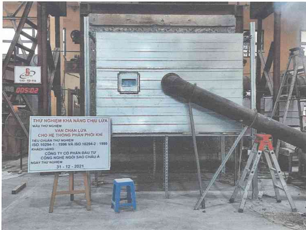
Ảnh D.4: Mẫu thử tại phút thứ 6 của quá trình thử nghiệm
