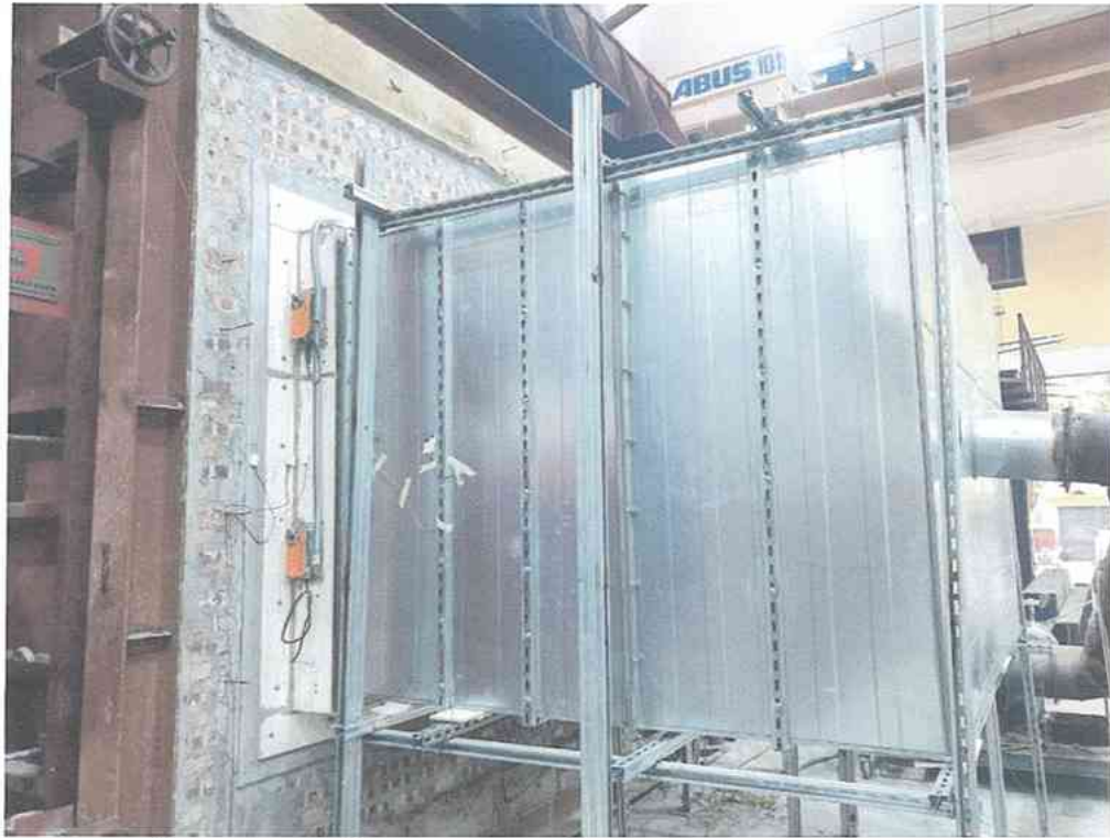
Ảnh D.3: Mẫu thử được lắp đặt vào lò thử nghiệm
