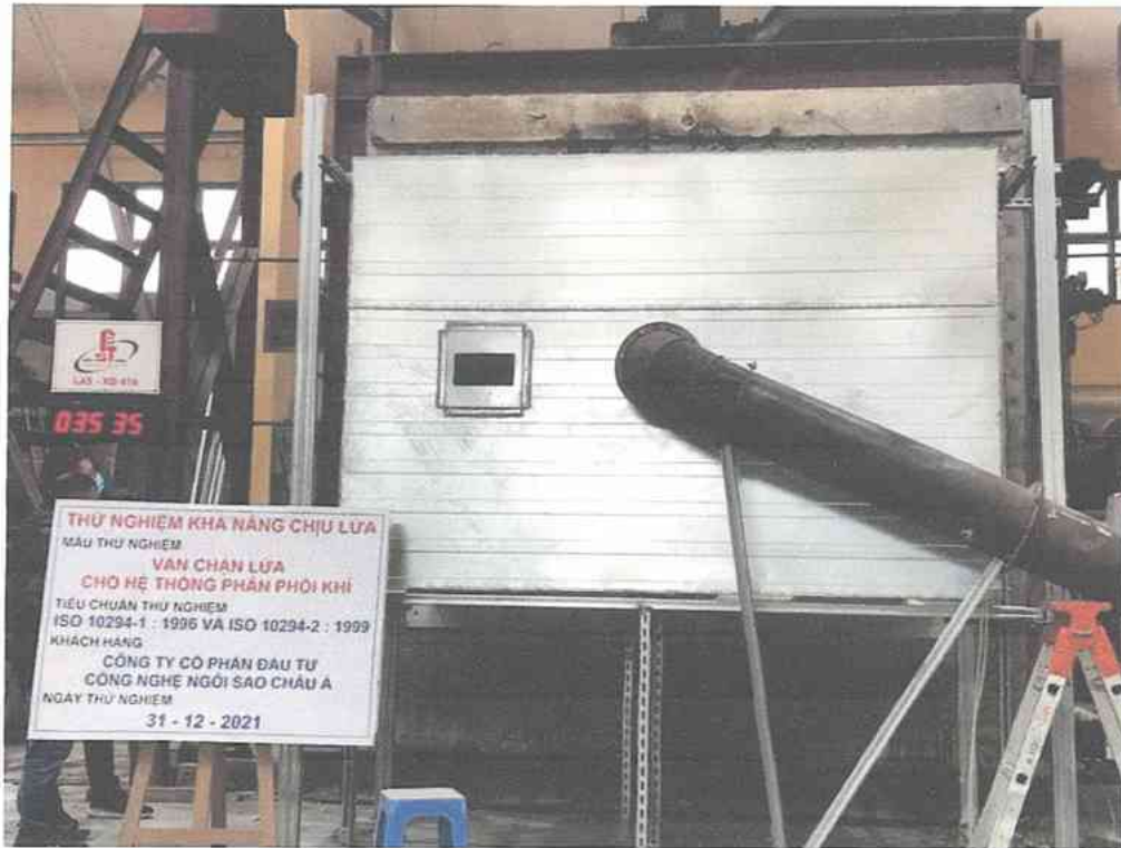
Ảnh D.7: Mẫu thử tại phút thứ 36 của quá trình thử nghiệm
