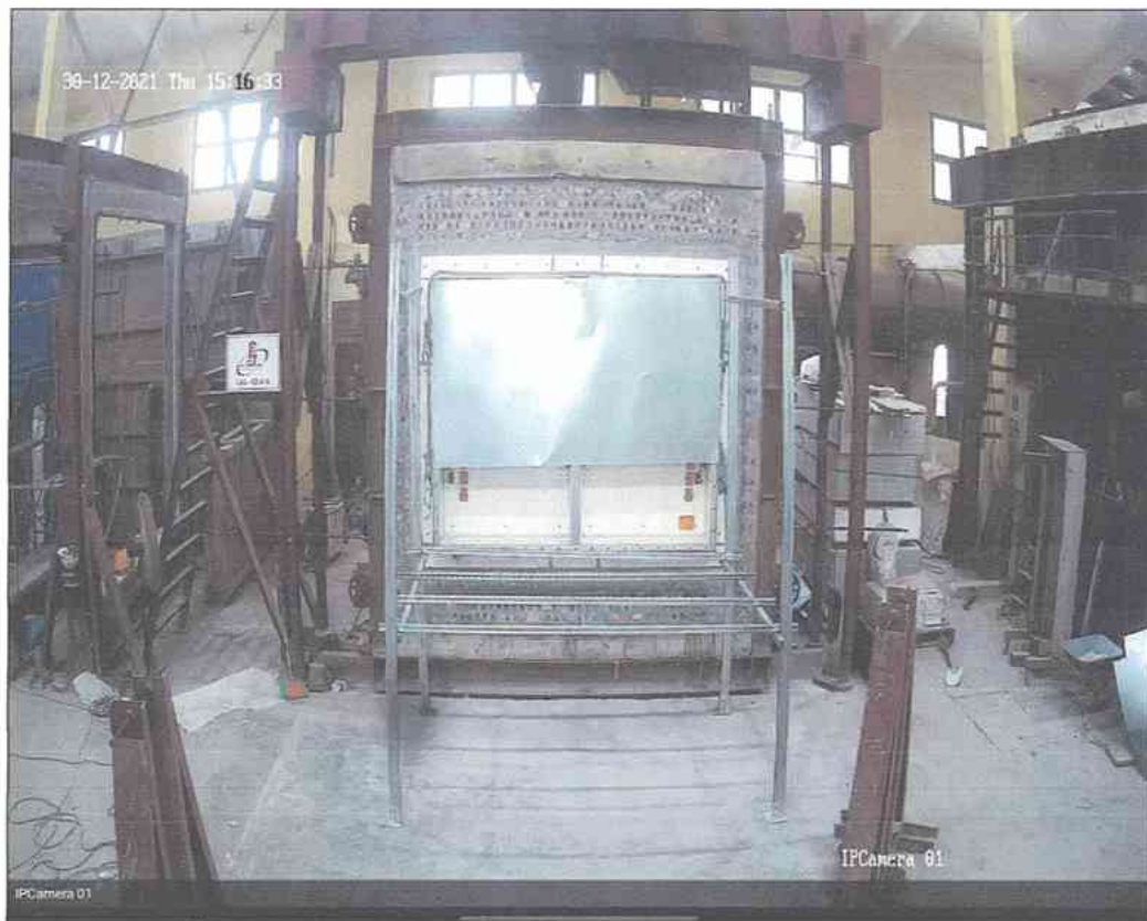
Ảnh D.2: Công tác lắp đặt mẫu van
