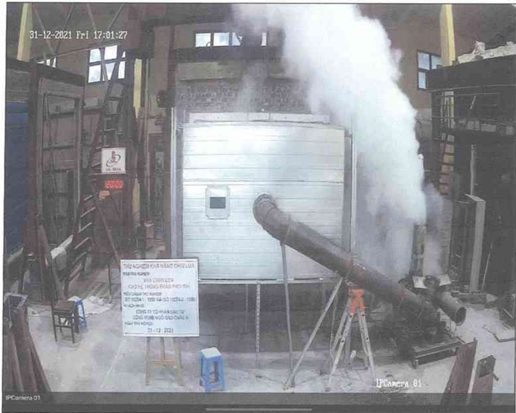
Ảnh D.11: Mẫu thử tại phút thứ 120 của quá trình thử nghiệm
