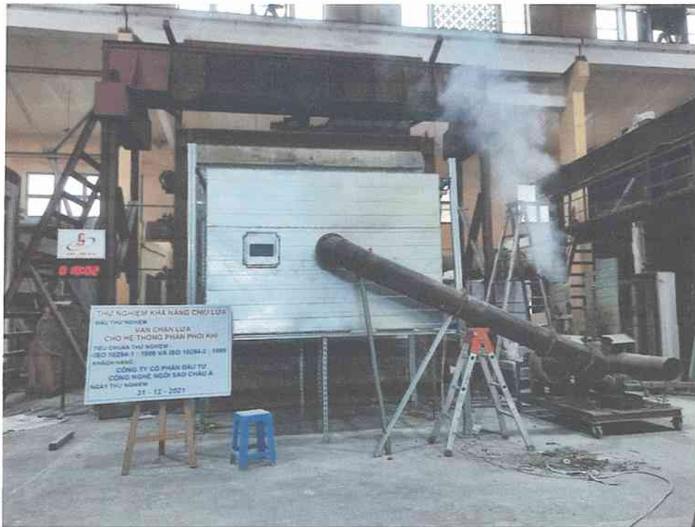
Ảnh D.5: Mẫu thử tại phút thứ 11 của quá trình thử nghiệm
