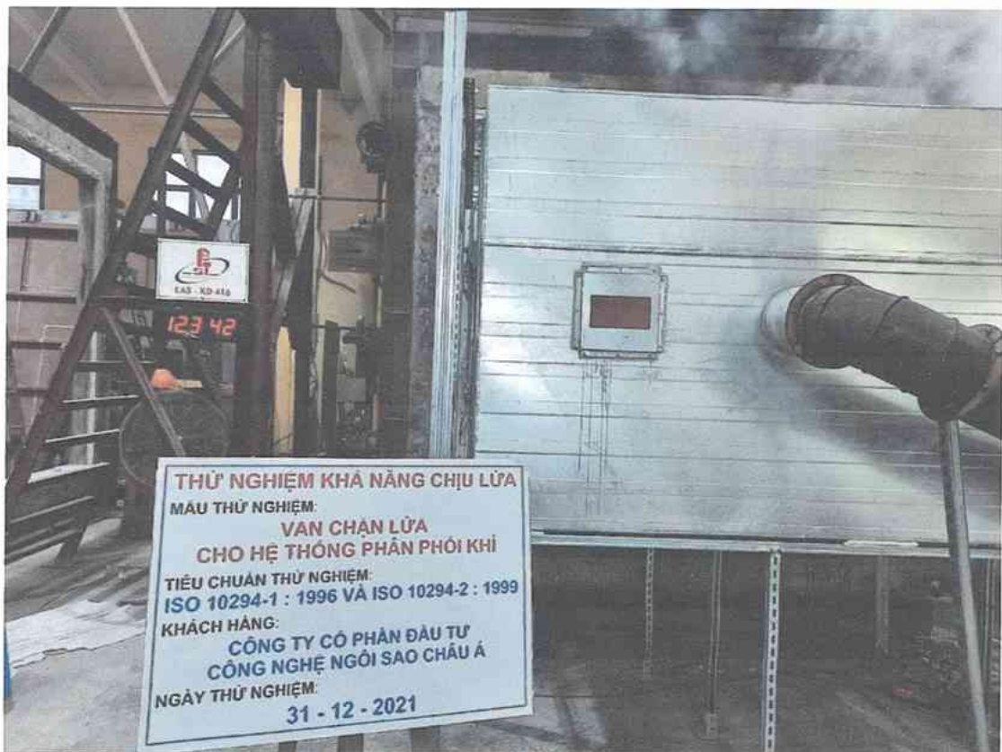
Ảnh D.12: Mẫu thử tại phút thứ 123 của quá trình thử nghiệm (dừng thử nghiệm)
